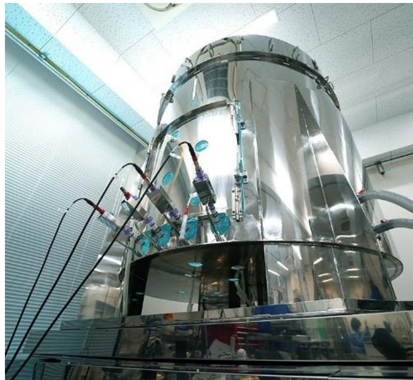
独自開発の動物細胞向け培養装置 (2,000 L)
